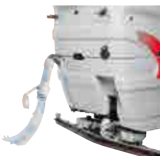
Leichte Entleerung des Schmutzwassertanks.
