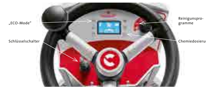
Das neue Bedienpult der Modelle 65 / 75 / 85 in der Automatikversion. Auf dem großen Digitaldisplay sind alle Informationen leicht verständlich erkennbar. Einfache Auswahl des Reinigungsprogramms über den Drehschalter (Fahren, Absaugen, Schrubben und Absaugen, nur Schrubben).
