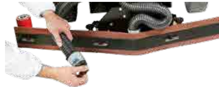
Einfacher und schneller Schmutzwasserablass.
